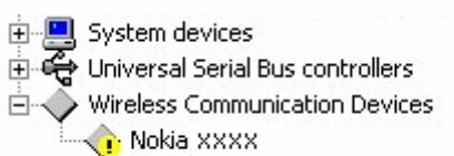
รูปที่ 2. การติดตั้งที่ยังไม่เสร็จสมบูรณ์ (xxxx หมายถึงตัวเลขรุ่นสี่หลักของโทรศัพท์)
